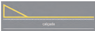
marcas de delimitação de parada de veículos específicos (amarela)
